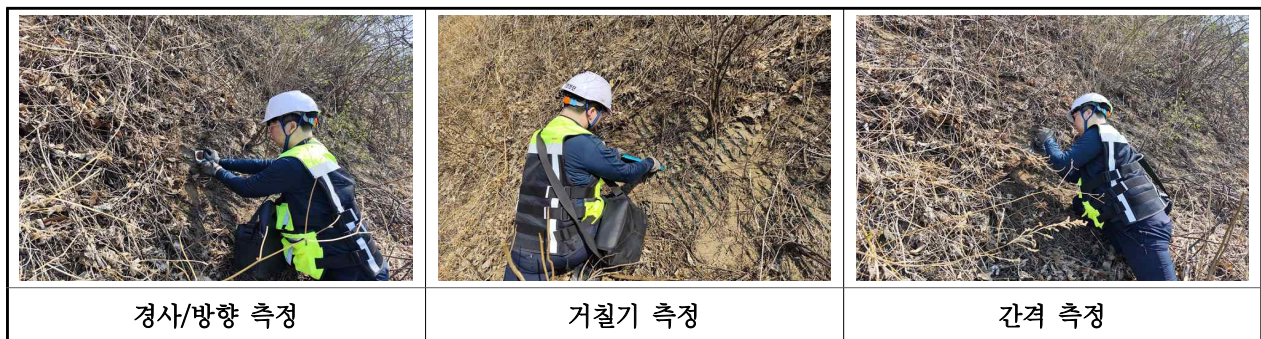
【사진 1.3.3】 1구간 불연속면 측정 현황
